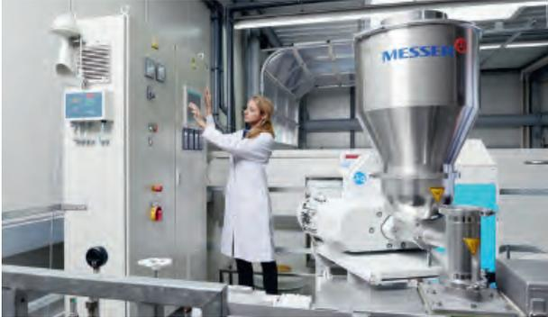
在测试过程中，实验室会测量并评估所有参数，如产量、耗电量、液氮需求量以及颗粒物粒径分布等，并向客户出具结果报告。这里的装置构造与实际生产的设备构造相同，所以测试结果具有实际参照意义，特别是针对全规模生产工厂。
