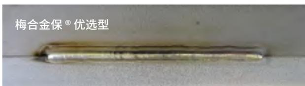
焊接厚的不锈钢板, 梅合金保® 优选型的焊道表面比氩气的更光亮, 氧化变色程度更轻。
