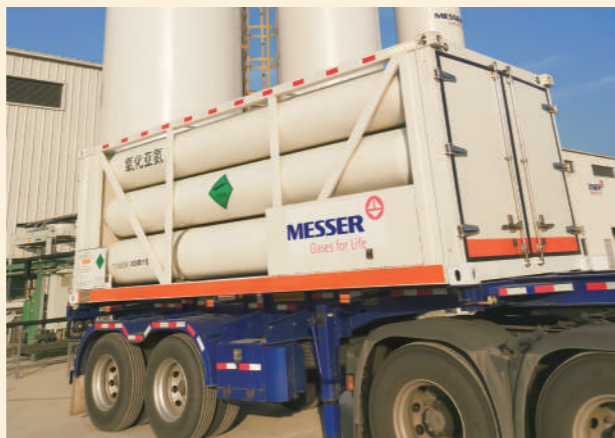
小规模客户供气方案 For smaller jobs 排管车 Tube trailer
