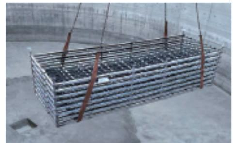
梅塞尔微孔曝气垫可以简单快捷的进行曝氧
