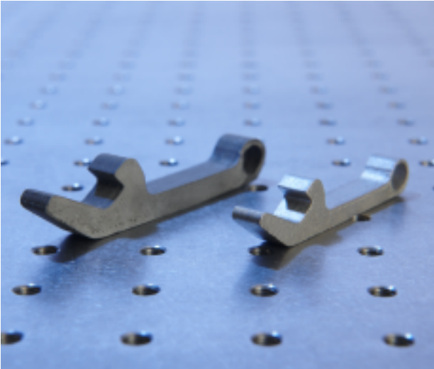
黏结剂喷射成形技术（左：生坯件，右：成品）
