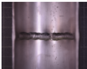
经过梅合金保氢5型气体保护的焊缝根部
