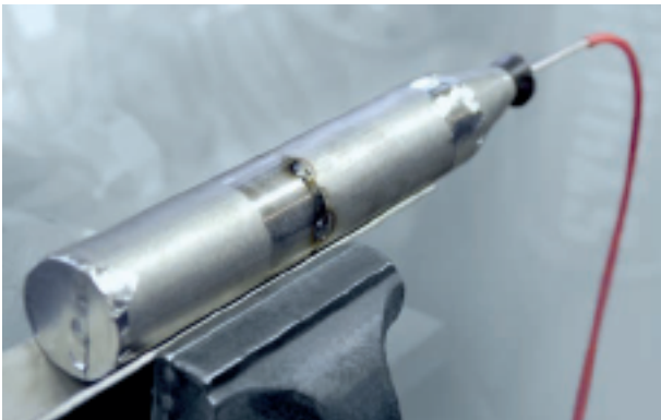
金属粉末烧结制成的手指状成形保护装置用在管道焊接的成形保护上
